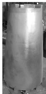
图 6 大型复杂圆台型钛合金铸件
